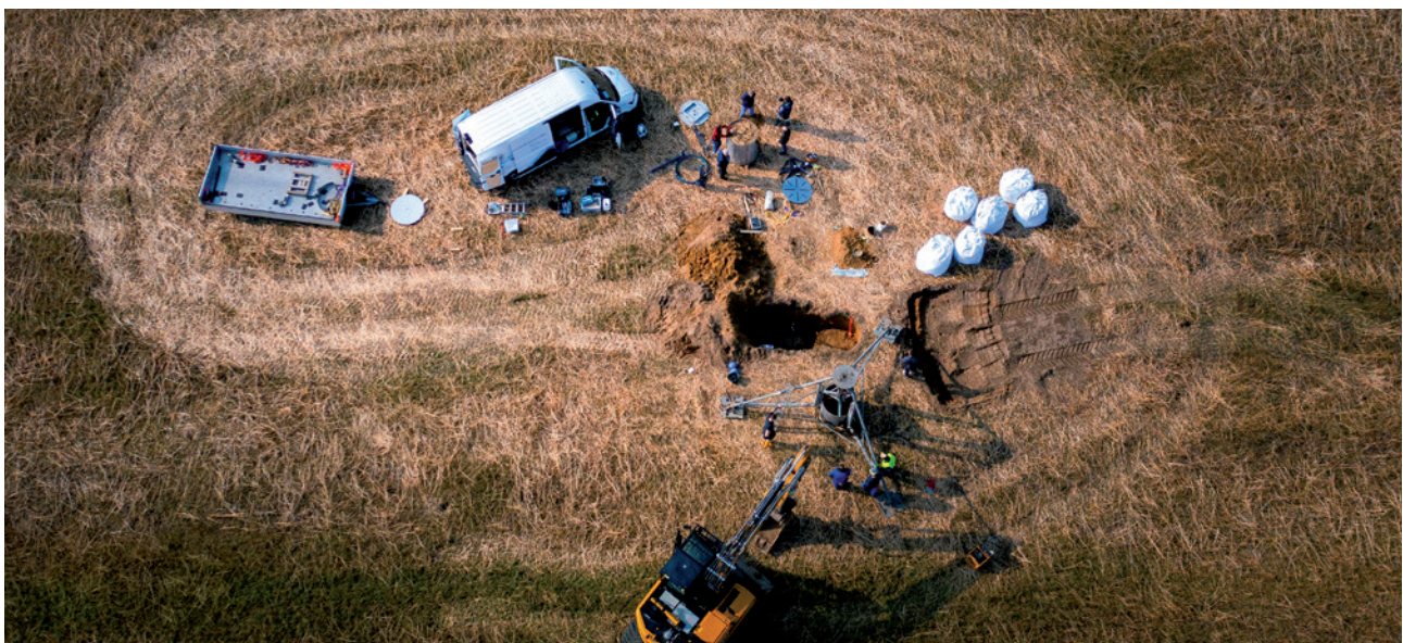
Feldarbeiten bei der Gewinnung von Lysimeterboden an einem brandenburgischen Ackerstandort. Quelle: Kento Ruhl, 2021.
